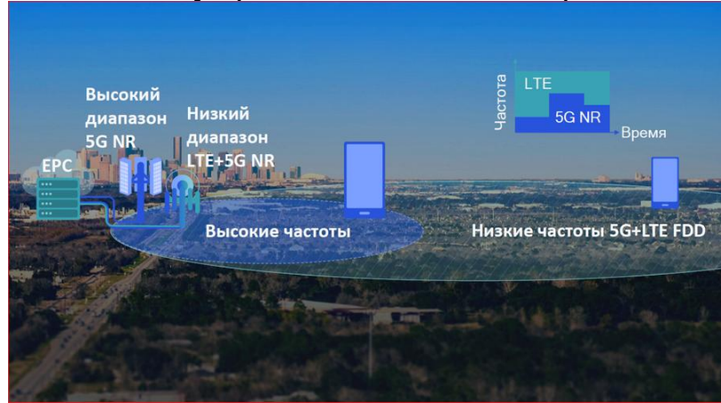
Рисунок 2.3 - Расширение зоны покрытия 5G за счет низких частот LTE
